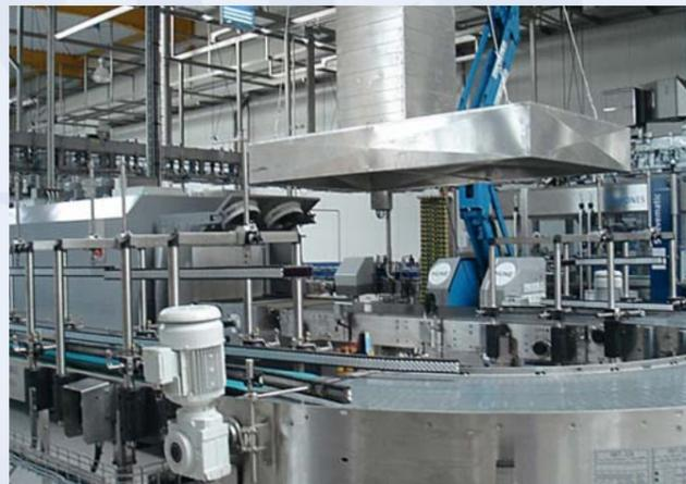
Direktabsaugung am Schrumperauslauf mit Bypassabsaugung
